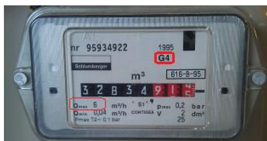
G4 met max. capaciteit van 6 m 3 /h
