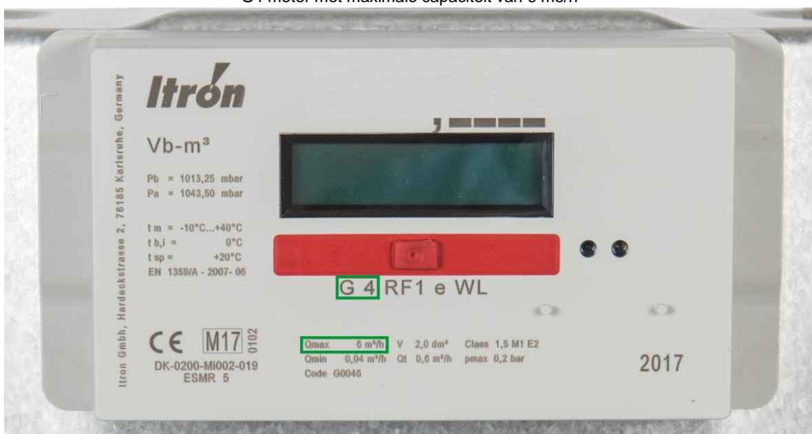
G4 meter met maximale capaciteit van 6 m 3 /h
